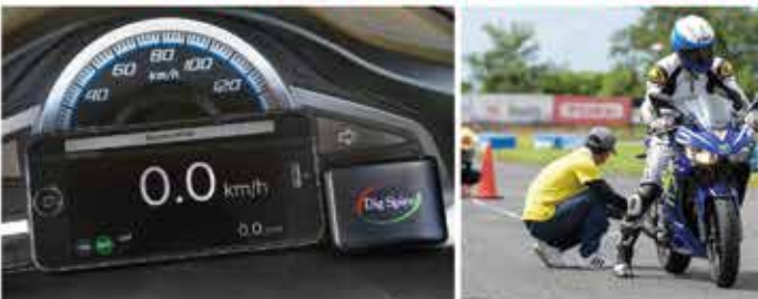
↑公正を期するため、スピードは実測値で統一。計測はGPSロガーの「デジスバイクII」で、スマホアプリの「デジスバイク・スピード」で数値を表示。
