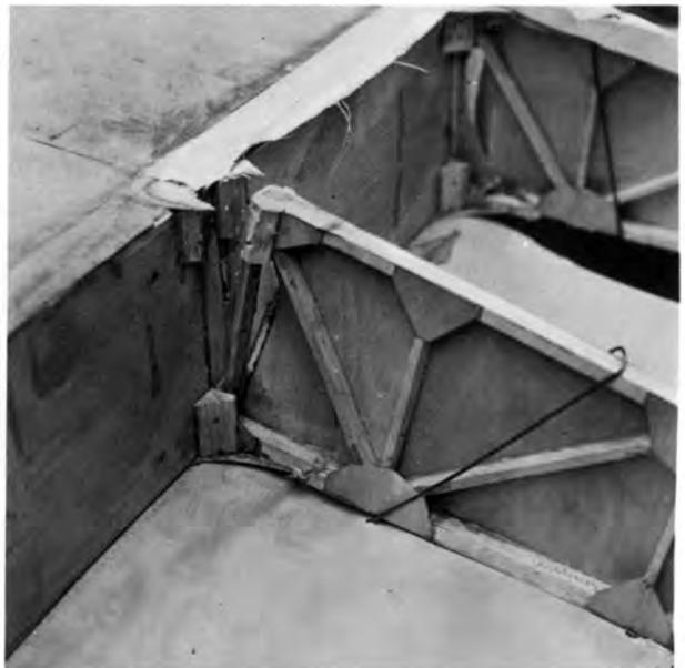
Mit dieser Last wurden verschiedene Rippenbauarten durchgerechnet, wobei sich ein größter Querschnitt von 4 x 4 mm ergab. Bei der ersten Erprobung knickte jedoch die erste Diagonale aus. Nach Erhöhen der Gurtquerschnitte auf 6 x 6 mm erreichte die Rippe die vorgeschriebene Festigkeit.
