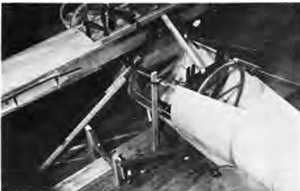
FS 16 Rumpf bei Torsionsversuchen
