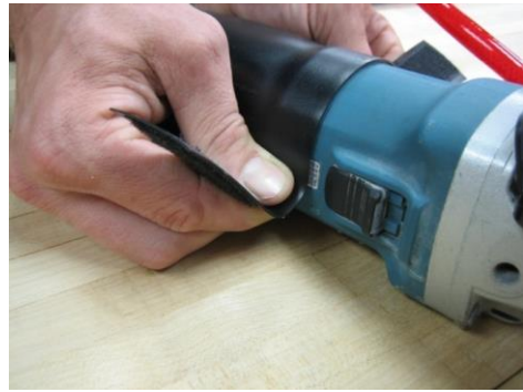
FIGURA 5 – Instalación del Delantal
