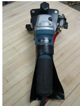
FIGURA 7 – Instalación del Delantal (Spray)
