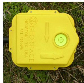
Figure 17 : Sens de mesure d'un géophone
