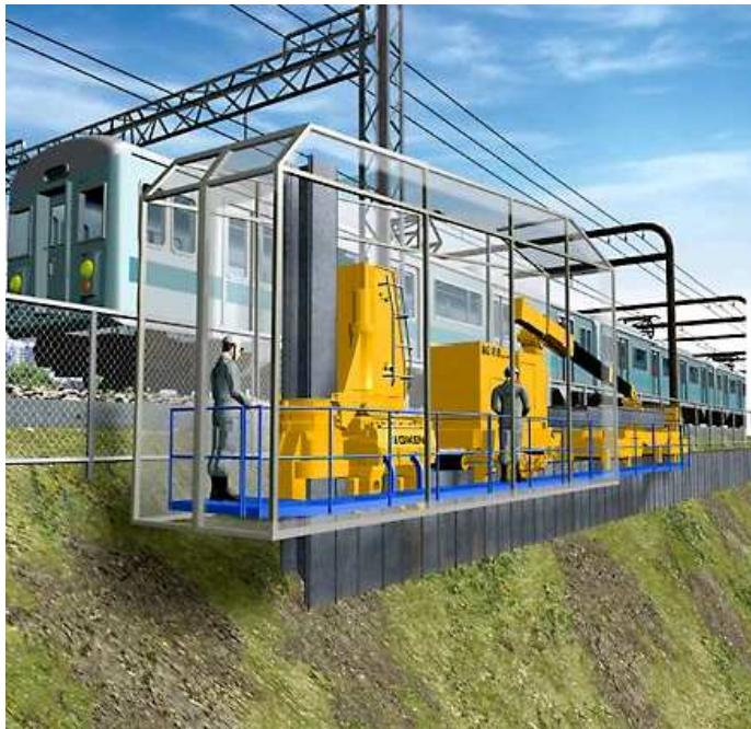
Figure 02 : Exemple d'opération de vérinage
