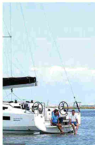
Le tableau arrière bascule pour faire office de jupe avec échelle de bords.
