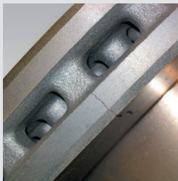
► Cracked brake disc
