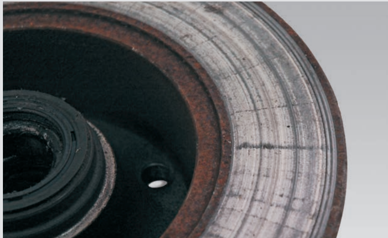
► Corroded brake disc
