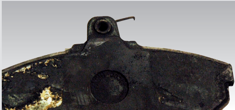
► Hold-down spring broken
