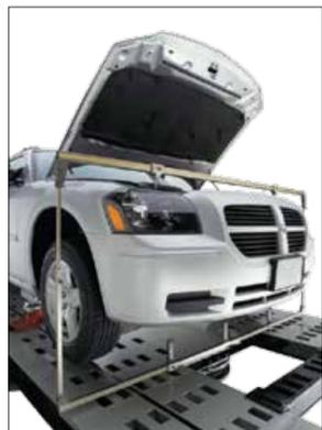
**Измерения в реальном времени с использованием комплекта реек для кузова**
