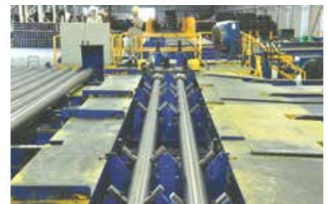
Kiểm tra thủy lực
