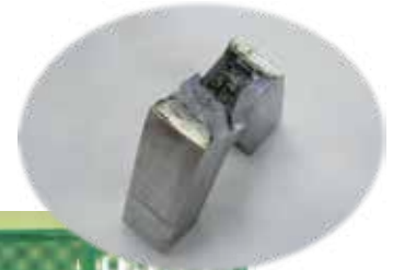
Bề mặt đứt gãy khi thí nghiệm
