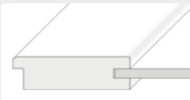
Rahmentürkonstruktion mit eingesetzten Füllungen, Rahmenfriesen aus MDF
