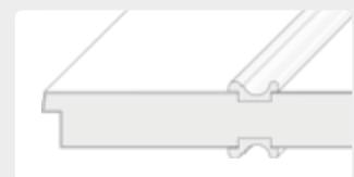
Türblatt mit eingefrästen und aufgesetzten Leisten.
