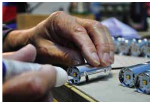
Abb.: Mit viel Liebe werden die Elektro-Komponenten von Hand geklebt, gelötet und montiert. Die Leuchten sind so konstruiert, dass alles ausgetauscht werden kann.
