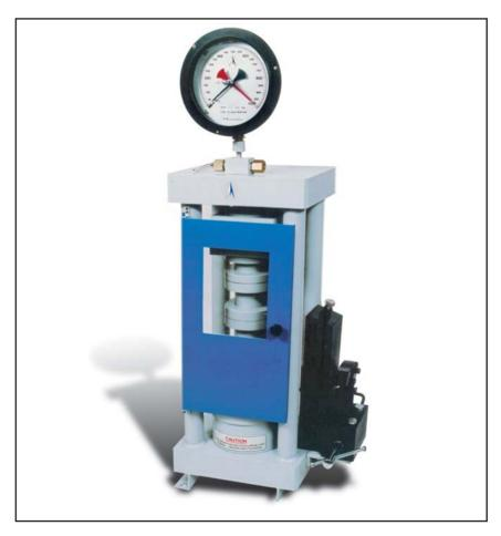
HAND OPERATED COMPRESSION TESTING MACHINE
