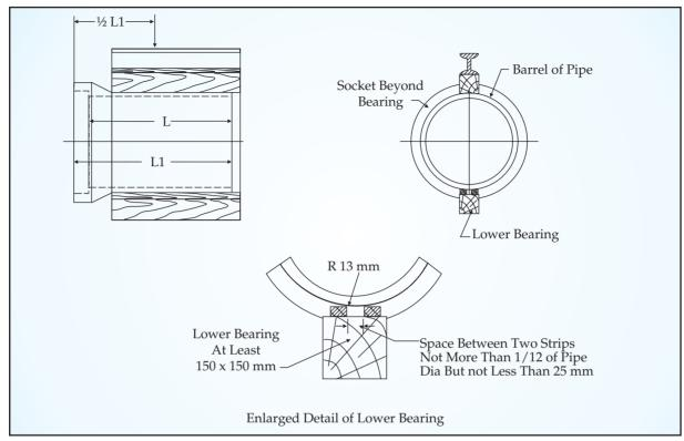
Figure 11. Three Edge BearingFigure 11. Three Edge Bearing
