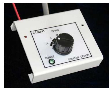
C1/BS-41 コントローラ CY402用の3-バンドコントローラ です。コントローラ部は組立・配線 キット式。 CL40B-5, CL40DXは電源のON-OFF式 の為、コントローラは有りません。
