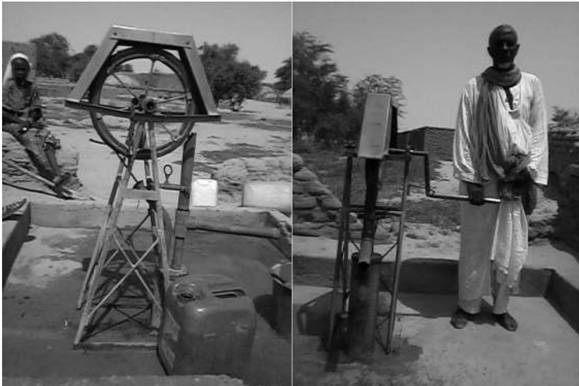
Figure 2: (a) Point d'eau à Temera, forage à faible coût équipé avec une Pompe à Corde (gauche); (b) Point d'eau à Temera, forage à faible coût équipé avec une Pompe à Corde installée en déc. 2007 (droite)
