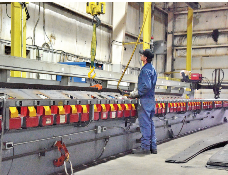
A hydraulic clamping frame rail fixture used to produce the main frame rails of Gincor's trailers. The machine clamps the webbing and rail flanges in position, so an automated beam welder can weld both the top and bottom simultaneously, requiring only one pass to complete the rail. | Un appareil de serrage hydraulique de longeron qui sert fabriquer les principaux longerons des remorques Gincor. La machine positionne l'armature et les bords de longeron et en effectue le serrage, de sorte qu'une machine à souder articulée peut souder en même temps les parties supérieure et inférieure, ce qui ne nécessite qu'un seul passage pour terminer l'assemblage du longeron.
