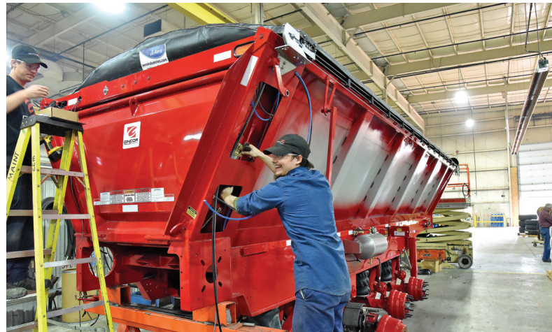
A live bottom trailer, model number 304LBC-S, being assembled at the Gincor Trailer Werx division in Blenheim, Ontario. | Assemblage d'une remorque à fond mobile, modèle nombre 304LBC-S, à l'usine de la division Gincor Trailer Werx, de Blenheim, en Ontario.
