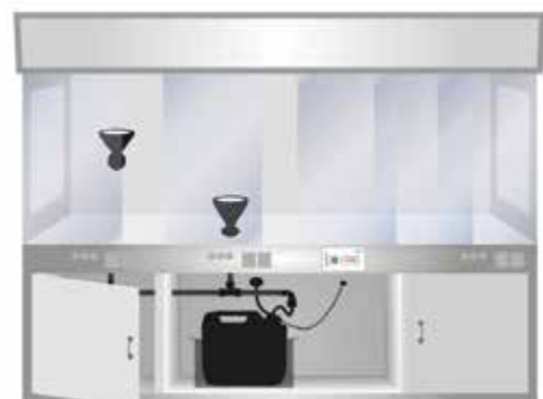
SCAT sistem: Primer izgleda instalacije na digestorima
