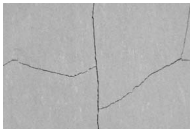
コンクリートにできた細かいひび割れ
