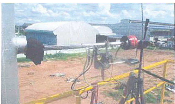
ตรวจวัดคุณภาพอากาศจากปล่อง
