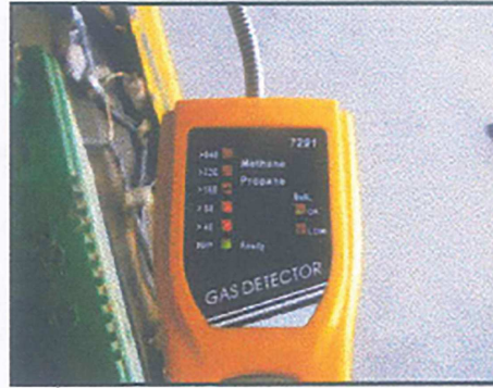
การตรวจสภาพการทำงานอุปกรณ์และส่วนควบคุมของระบบก๊าซ สกโพรคลิฟ
