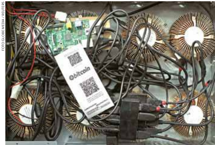
Stroj na těžbu bitcoinu a papírová peněženka s QR kódem, pod kterým je uložena virtuální měna.
