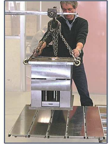
PARK PICK UP Plateaux profilés acier galvanisé.
