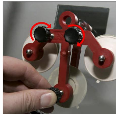
Se ajusta un cilindro de inyección dentro del agujero roscado hasta que la punta esté a 1 mm del cristal. Sujetando el puente de reparación por los puntos de montaje de las ventosas puede moverse todo el equipo hasta que el punto de impacto se sitúe justo por debajo del sello del inyector.
