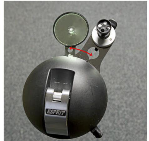
Hay una lengüeta pequeña montada en el parte posterior del sujetador del inyector. Si la levanta al tiempo que mueve el brazo hacia un lado reducirá la presión del sello del inyector y limitará la posibilidad de dañar el sello cuando lo desplace al punto de impacto.
