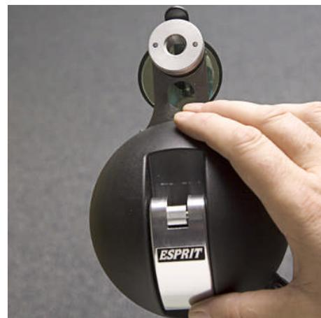
A continuación apriete el cilindro del inyector contra el cristal hasta que uno o los dos pies de apoyo frontales del sujetador del inyector se separan de la superficie del cristal. (No confunda el pie pequeño de la cabeza del inyector con el grande de apoyo del cuerpo.)
