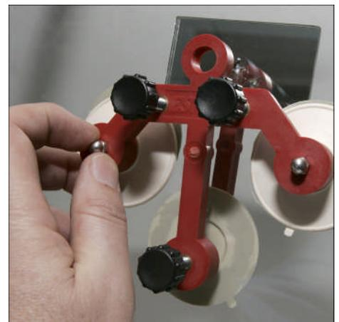
El brazo largo (tornillo 1) se sujeta hacia abajo al cristal y al MISMO tiempo los tornillos 2 y 3 se aprietan hasta que hagan contacto con el cristal.
