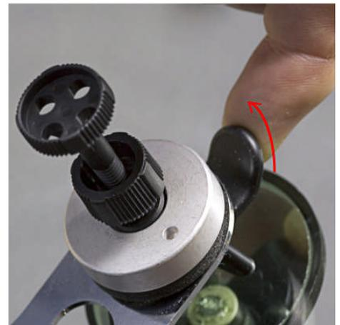
Limpie el exceso de resina e inspeccione la rotura. Después de la inspección, vuelva a poner la unidad del inyector en su posición sobre el área dañada, alinee los indicadores de posición y aplique la presión.
