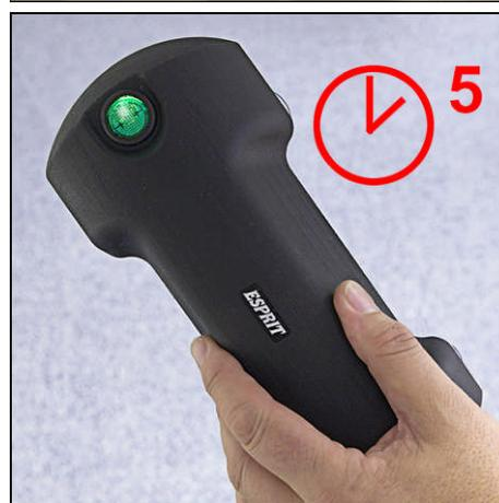
Retire la lámpara girándola de lado a lado para soltar las ventosas. Quite el trozo de película de plástico. Ahora habrá una pieza de resina endurecida sobre el punto de impacto que tendrá que rasar al ras de la superficie del cristal.
