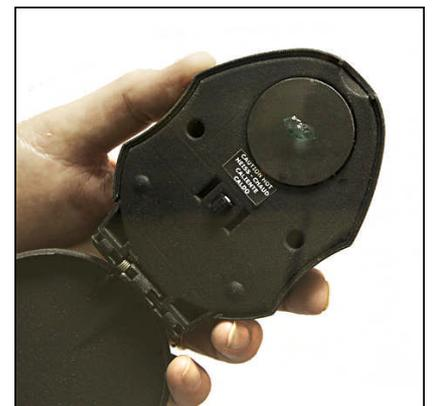
soltará automáticamente y la unidad comenzará a calentarse. Un aumento local de temperatura de entre 15 - 18°C es suficiente. Como norma general, si el cristal está demasiado caliente al tacto con la yema de los dedos, entonces está demasiado caliente.
