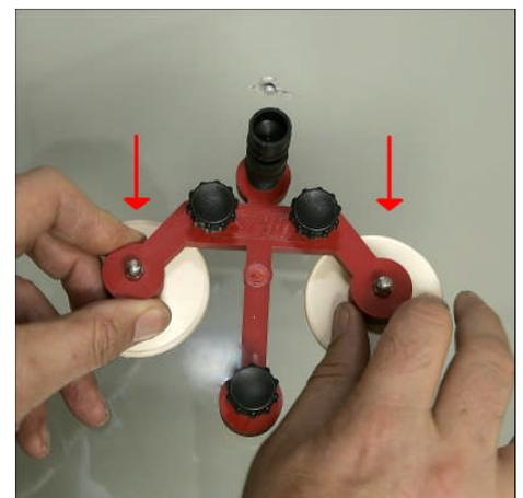
Si la reparación parece perfecta entonces acabe el proceso. Para ello sujete un tisú o un paño en el lado del inyector de forma que pueda recoger cualquier exceso de resina al retirarlo (todavía bajo presión) por última vez. Corte un cuadrado pequeño de la película plástica de UV para el endurecimiento y póngala sobre la rotura.
