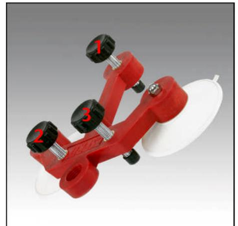
Se coloca el puente de reparación en el cristal con el agujero roscado sobre el área dañada y se presionan las ventosas sobre el cristal. El brazo largo debe estar bien recto hacia arriba (como se muestra) o hacia abajo.
