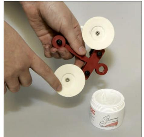
Hay tres tornillos de ajuste en el puente de reparación básico; No. 1 está al final del brazo de ajuste largo. No. 2 y 3 son un par de tornillos de sujeción cerca del sujetador del inyector roscado.
