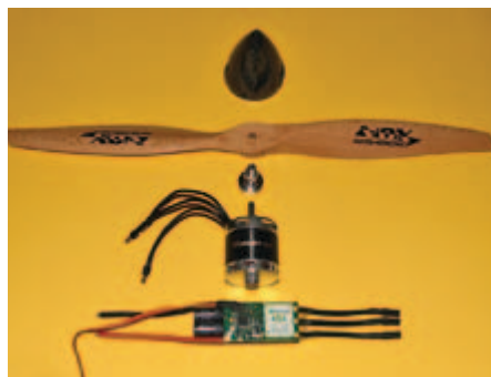
Die Antriebseinheit: Quantum 45-A-Regler, Thrust 40-Außenläufer, Präzisionsmitnehmer, VOX-Holzluftschraube, CFK-Spinner und Smart Devil 3s 2.200 mAh 35C-LiPo.
