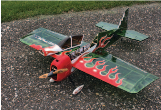
Der Zugang zum Rumpf und den Akkus erfolgt über die große Kabinenhaube – hier erkennt man den vergleichsweise schmalen und hohen Aufbau des Rumpfes.
