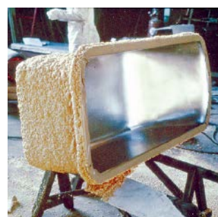
浴槽の断熱・ガタつき防止
