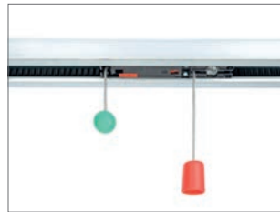
Notentriegelung Bei einem Stromausfall kann das Tor über die Notentriegelung sicher geöffnet und wieder geschlossen werden. Durch Ziehen der Entriegelung wird das Tor vom Antrieb getrennt. Das Tor kann manuell bedient werden.
