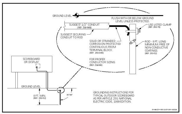
FIGURE 11 — TYPICAL GROUND WIRE CONNECTION
