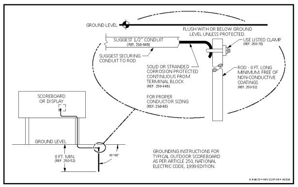
FIGURE 23 — TYPICAL GROUND WIRE CONNECTION
