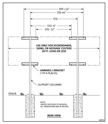
FIGURE 5. SUPPORT SPACING FOR VARIABLE SCOREBOARD MOUNTING SYSTEM
