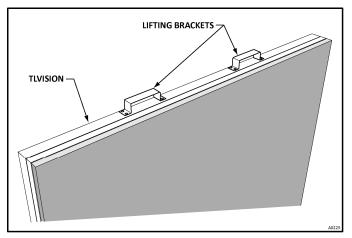
FIGURE 13 — LIFTING BRACKETS
