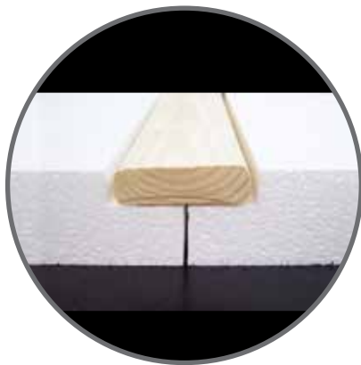
COUPE ENCAVÉE Épaisseur de 1 po (25mm) et plus
