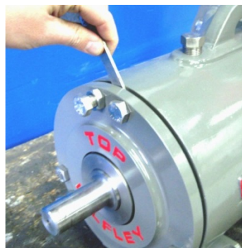
Figura 23: Método con galga de espesores
