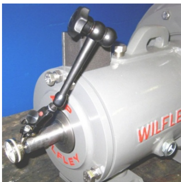
Figura 22: Método con indicador de carátula (método preferido)
