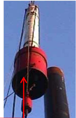
Figure 25 Exemple de casque de battage pour marteau hydraulique IHC Source : IHC.fr
