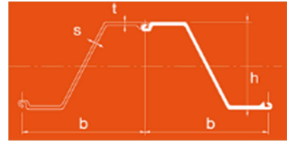
Figure 4 Exemple de profil en Z. Source: ArcelorMittal
