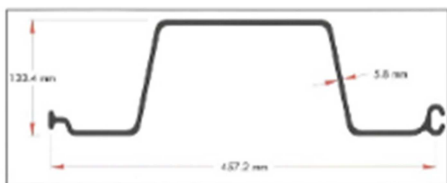
Figure 13 Exemples de palplanche en vinyle profils Z et U (PVC). Source : jinternational.nl
