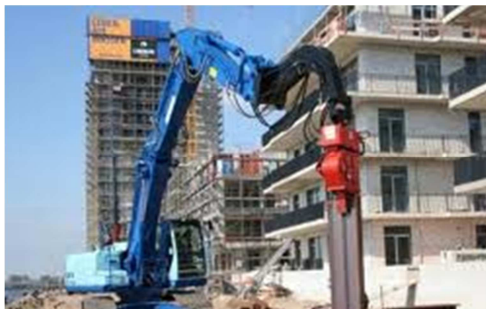
← Figure 29 Exemple de vibrofonçeur à fréquence standard monté sur une pelle hydraulique. Source : PTC-Fayat Group
