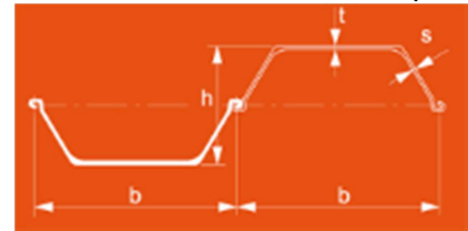
Figure 5 Exemple de profil en U. Source: ArcelorMittal
