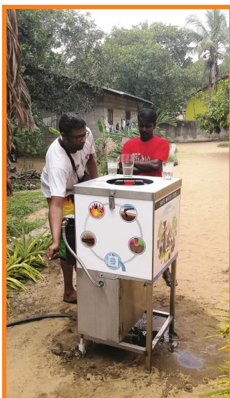
Ce cube en inox de 1,20 mètre de côté contient cinq filtres différents et traite jusqu'à 1.000 litres par heure. © SAFE WATER CUBE
