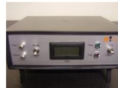
MET迷你耐破度测定仪设计用于洁净室内的简单操作。包装可以直接从产品上取下，并在这个实用的“通过”/“不通过”量规上进行为时数秒的测试。
