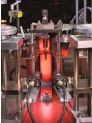
Innenangriffsprüfung Pinhole Inspection
