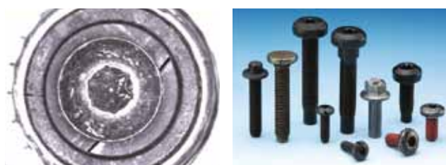
Kopfrisse an der Seite bei schwarzen Schrauben Black Screw of Wheel Crack
