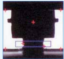
Gewinde unter Kopf Ineffective Thread Length
