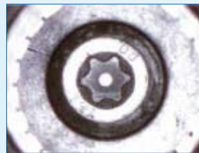
Kopfrisse an der Seite bei verzinkten Schrauben
