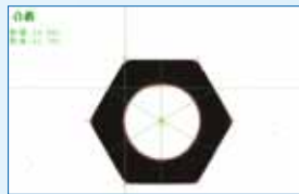
Schlüsselweite / Eckenmass AF / AC
