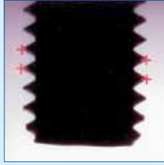
Gewindebeschädigungen Thread bevel
