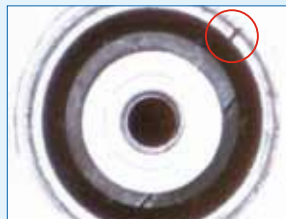
Kopfrisse an der Seite der Flanschmutter
