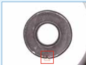
Kopfrisse Head Crack
