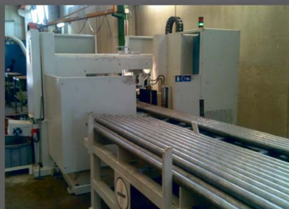
Segatrice con magazzino di carico automatico.
