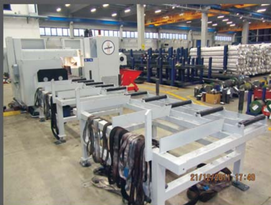
Rulliere con porta fascio per una maggiore sicurezza e facilità di carico
