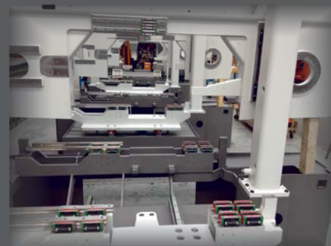
Segatrice con magazzino di carico automatico.
