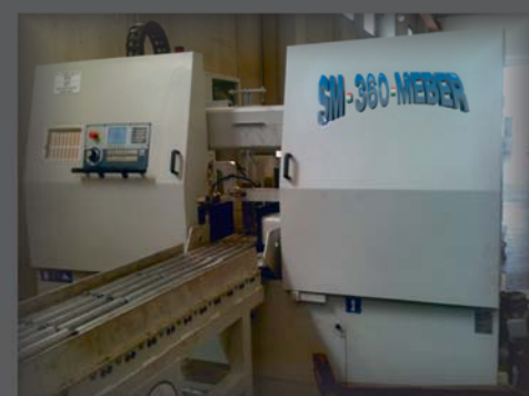
Segatrice con magazzino di carico automatico.
