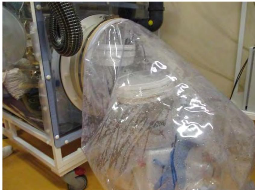
Anschließend wird die Schleuse über die Sprühöffnungen nochmals gut eingesprüht, besonders wichtig ist dabei die Verbindungsstelle zum Isolator! Die zweite Person hilft dabei die Gnotokäfige immer so zu verschieben, dass alle Stellen gut erreicht werden können und die Luft in der Schleuse am Ende gut mit Peressigsäure-Aerosolen gesättigt ist. Die Sprüh-öffnung zügig verschließen.
