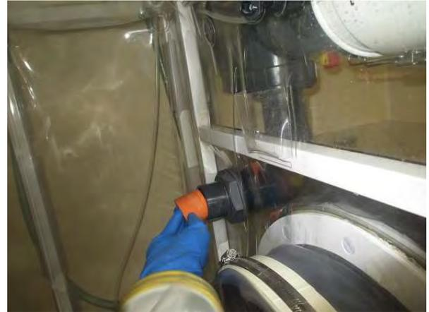
An der Decke des Isolators beginnen, Rückwand, Seitenwände, Boden und übriges Material systematisch besprühen. Besonders sorgfältig bei schwierig zugänglichen Stellen arbeiten, wie z.B. die kleinen Taschen an den Seitenwänden, die Anschlußstellen des Druckschlauches, die Ecken und um den Port herum.
