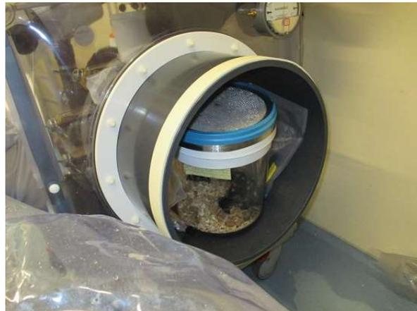
Jetzt die Schleuse / Tonne / „Bag“ in die richtige Position bringen und den Wagen oder andere Vorrichtung so ausrichten, dass die Käfige in der Schleuse / „Bag“ in der Einwirkzeit abgestellt werden können.
