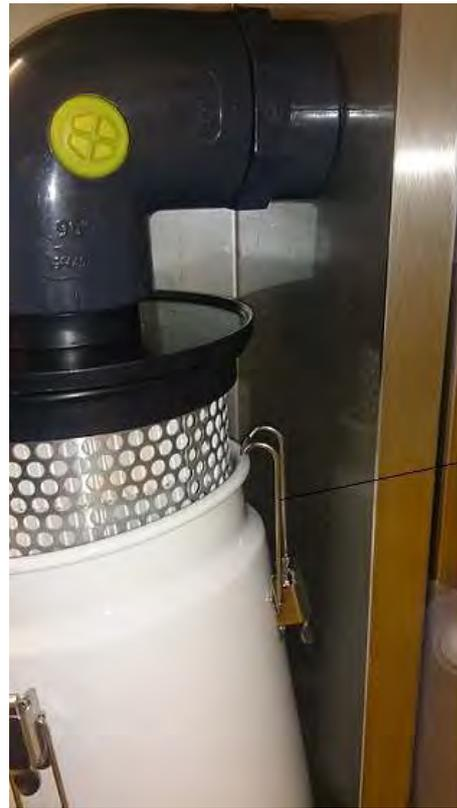
Bei der Abdeckung, Verschlüsse hochgeklappt einsetzen
