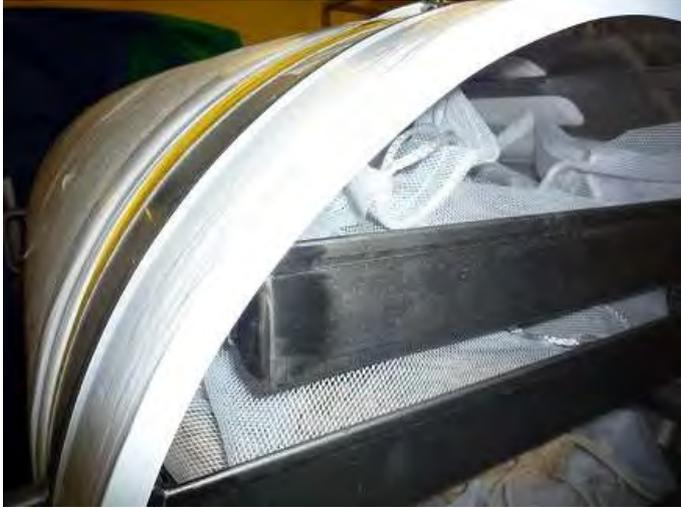
Bei einer zweiten Runde wird es etwas mehr nach vorne gezogen damit sich dort ein ca. 1 cm breiter Rand um das Ende der Tonne legt. Ist der Kreis komplett, das Klebeband wieder leicht nach hinten führen, damit man es ohne Falten am Rand der Tonne abschneiden kann.
