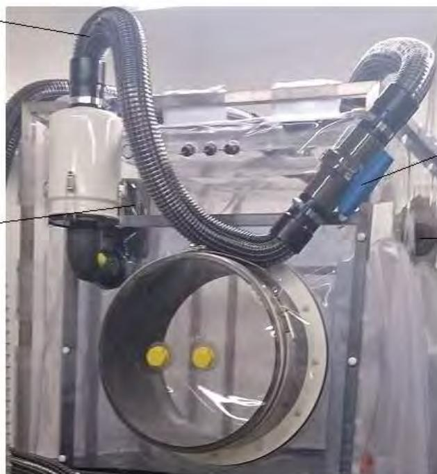
Ventil entfernen oder komplett öffnen
