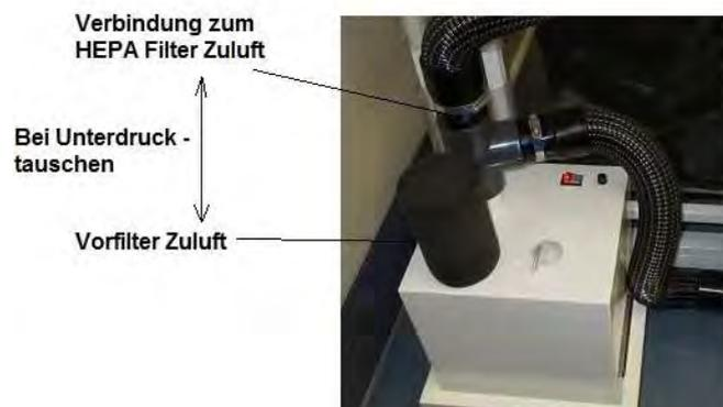
Schlauch entfernen und Vorfilter anbringen, da im Unterdruck nun Zuluft
