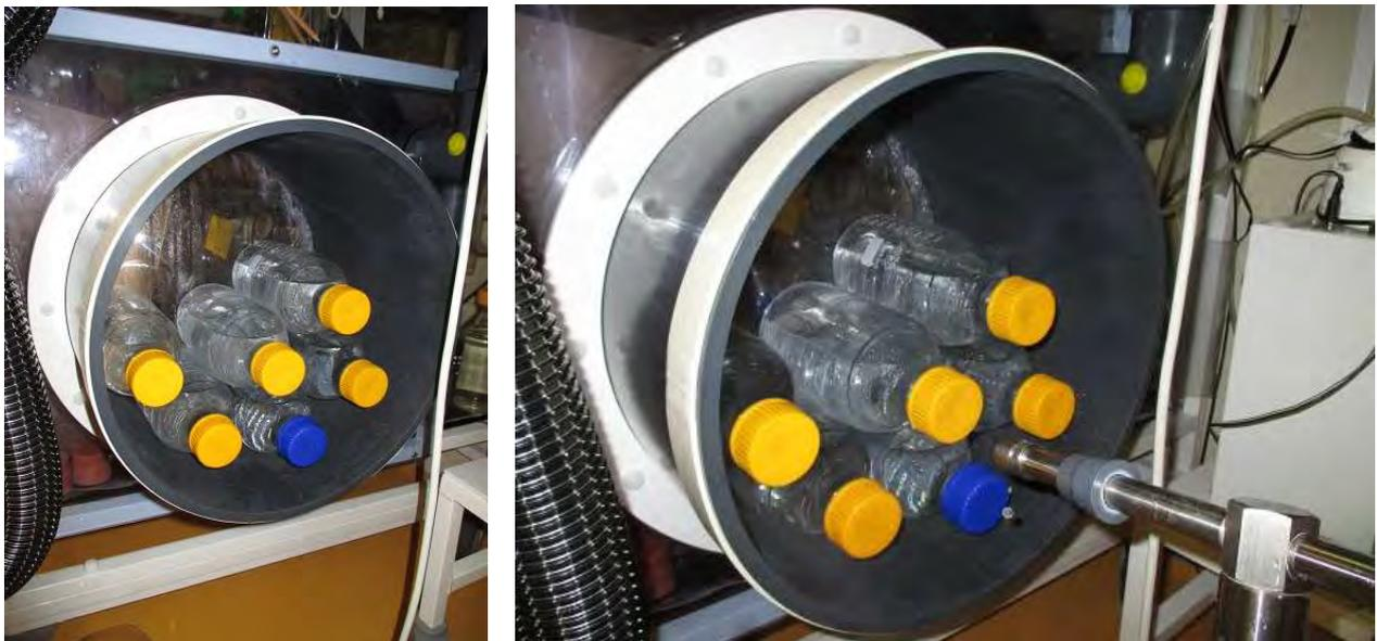
Sind alle Flaschen im Port (maximal 9 1L Flaschen möglich), wird noch einmal über alle Deckel gesprüht und anschließend entweder die Schleuse der Tonne / für den anderen Isolator, oder die Portkappe eingessprüht und angebracht.
