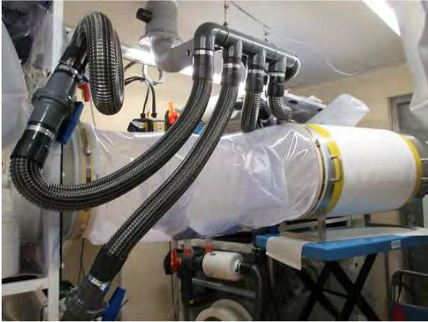
Durch die Sprühöffnungen der Schleuse wird diese nun systematisch eingesprüht.
