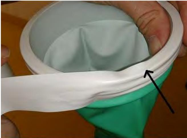
Wird das Klebeband nicht straff genug gezogen bilden sich Falten und später kann sich das Klebeband leicht lösen!!
