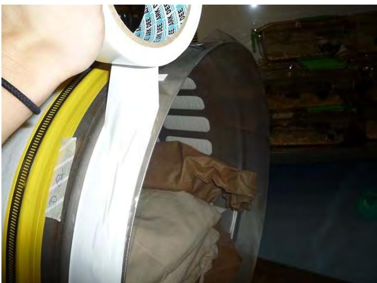
Ist alles gut fixiert benutzt man das 5cm breite Klebeband und klebt alles gut fest. Dabei das Klebeband gut straff ziehen um Falten zu vermeiden. Man beginnt ca. 5mm hinter den kleinen Klebestreifen und zieht das Klebeband eine Runde um die Tonne um alle Klebestreifen abzudecken.
