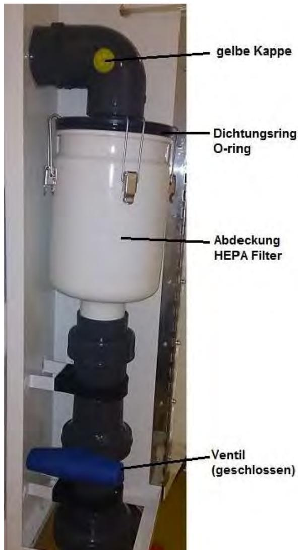
Die gelben Rohrkappen und die Dichtung zum HEPA Filter sind hier die häufigsten Gründe warum Luft austritt. Ein anderer Grund kann natürlich auch sein, das das Ventil an sich nicht mehr dicht schließt, oder die Gummidichtung am Filter porös oder gebrochen ist. Alles hinter dem HEPA Filter beeinträchtigt nicht die Sterilität des Isolators, aber ein Wechsel diverser Komponenten sollte immer vor Inbetriebnahme erfolgen
