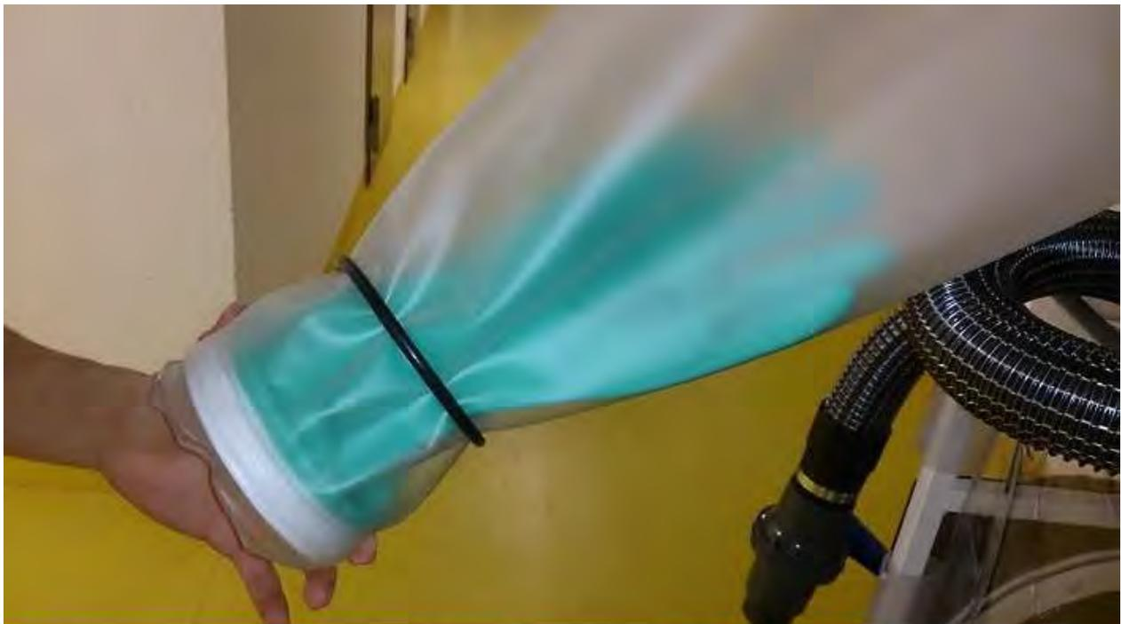
Zweiten O-Ring über den Ärmel stecken, dann den Handschuh so weit zurückziehen das der Plastikring bündig mit dem Ende abschließt. Dann mit dem O-ring fixieren.
