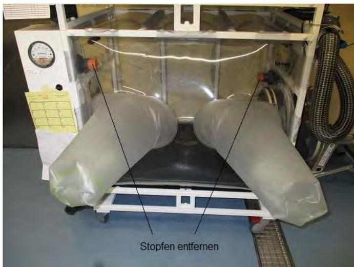
Die blauen Ventile der Zu- und Abluft nun so regulieren, dass ein konstanter Druck von ca. 125hPa angezeigt wird. Die Ventile sollten dabei eher auf einer offenen Position stehen um eine gute Luftzirkulation zu gewährleisten. Das heißt zuerst wird das Abluftventil komplett geöffnet, dann die Zuluft. Die Anzeige beim
