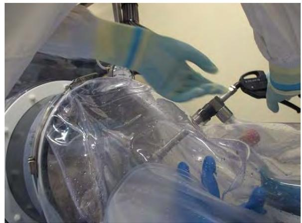
Alle Oberflächen sollen dabei gut benetzt werden. Das Sprühen soll wiederum, wie schon bei der Sterilisation des Isolators, in kurzen Sprühstößen erfolgen um eine gute Aerosolbildung zu gewährleisten. Besonders gründlich sind die Handschuhe und Ärmel der Schleuse einzusprühen. Die Schleuse bläht sich bei dem Einsprühvorgang etwas auf. Die Kappen beim Herausziehen der Sprühpistole einsprühen und die Öffnung zügig verschließen.
