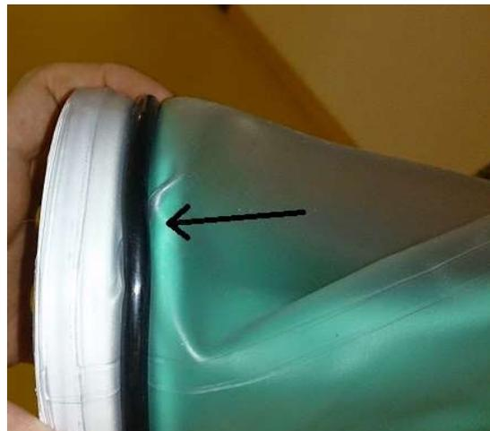
Nun wird das ganze noch mit dem Klebeband fest angeklebt. Auch hierbei wieder darauf achten, dass das Klebeband gut straff angezogen wird und sich straff und Faltenfrei um das Ende des Ärmels und den Plastik ring legt. Je besser dies angeklebt ist, umso besser hält der Handschuh.
