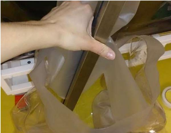
Den Bag und die Materialien darin am Besten schon vor dem anklebmen am Ärmel mit Peressigsäure aussprühen. Die am Ärmel angebrachte Klammer in den Bag stecken.
