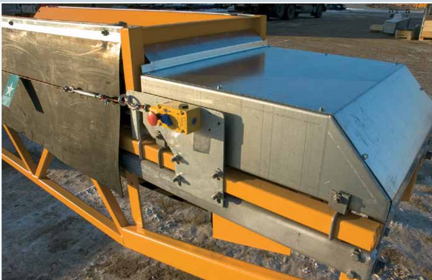
Spännsektion i standardutförande, i kapslat utförande. Tension section in standard encapsulated construction.
