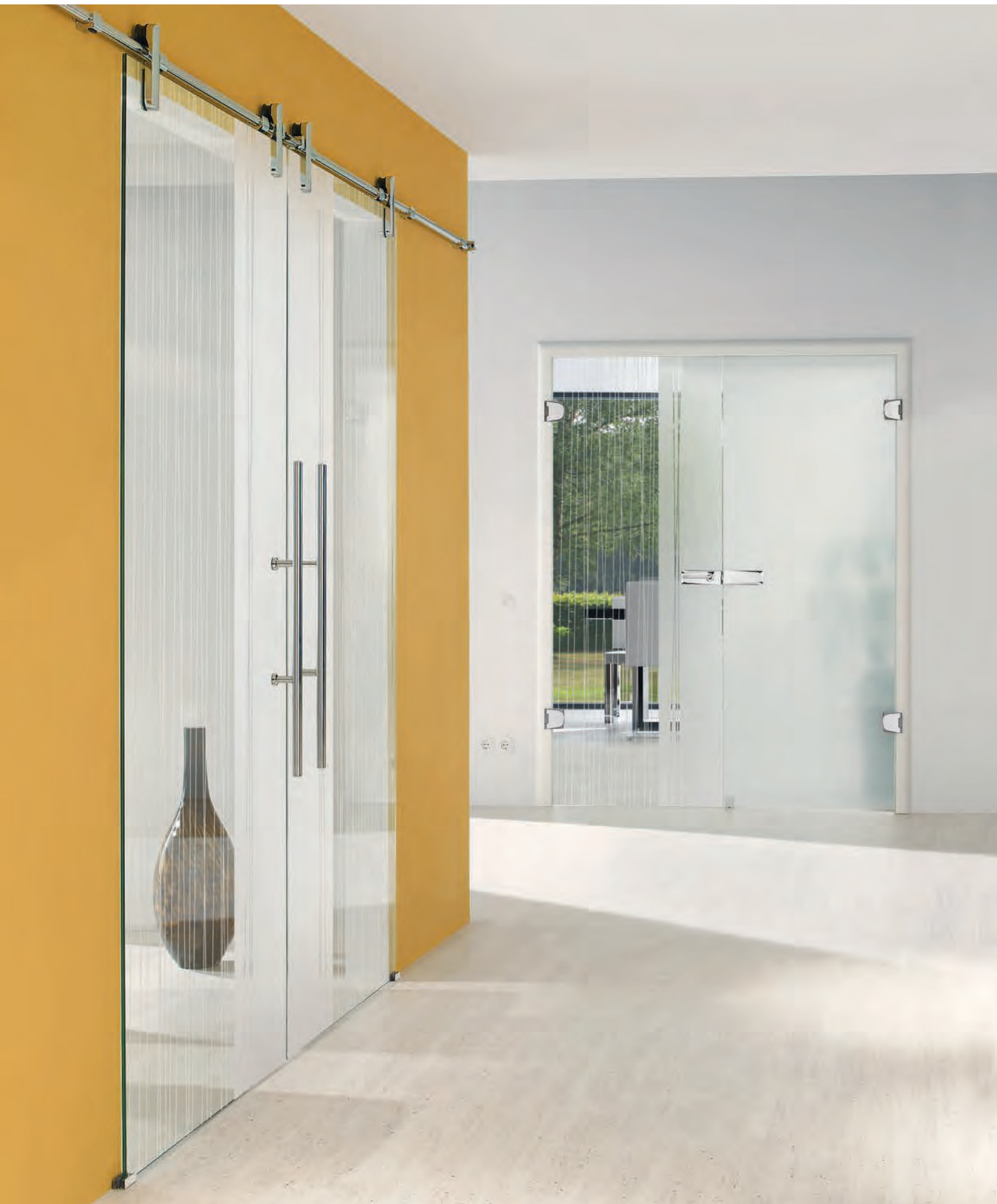
Türmodell links: Schiebesystem: Edition Style, Edelstahl Chrom Glanz poliert | Glasdesign: Stream Typ 1, Motiv matt /Fläche klar | Griffstange: L&H G 700 rund, Edelstahl Chrom Glanz poliert Türmodell rechts: Drehtür 2-flg. | Glasdesign: Stream Typ 1, Motiv matt /Fläche klar, Seitenteil Satinato, auch als VSG-Tür | Beschlagset: Bacio, ähnl. Chrom Glanz | Drücker: Valli H1044, Chrom glänzend
