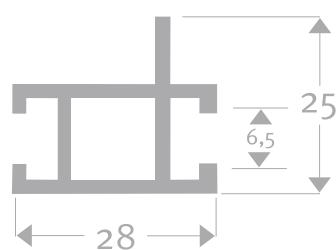
Hestex Doppelkammer mit Steg 6 mm
