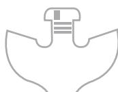
Hestex 180° Bodenträger mit Schraube
