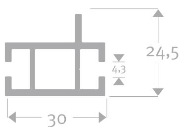
Hestex Doppelkammer mit Steg 4 mm
