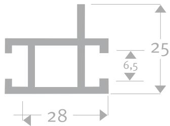
Hestex Doppelkammer mit Steg 6mm
