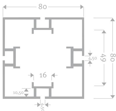
Hestex 80/80 Max Up Profil-Säule 4mm
