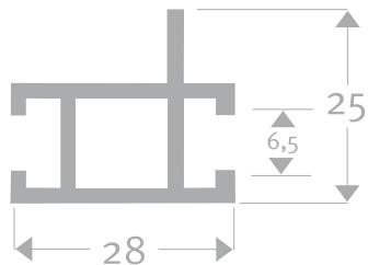
Hestex Doppelkammer mit Steg 6mm
