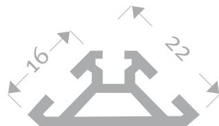
Hestex Prisma Basisprofil 90°
