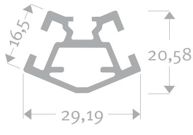
Hestex Prisma Basisprofil 135°
