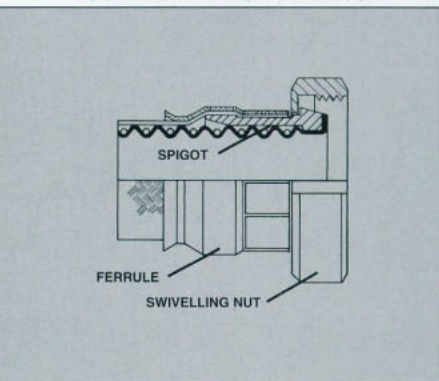
STANDARD DIN 11851 FITTING
