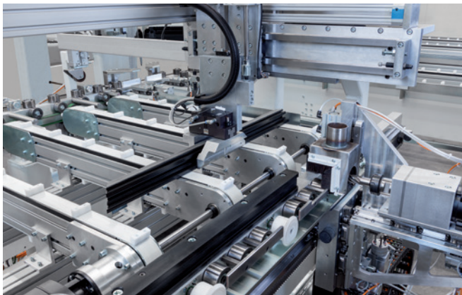
Fräs-, Bohr- und Sägeanlage für Stabprofile
