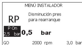
Figura 17: Configuración de la presión de reencendido
