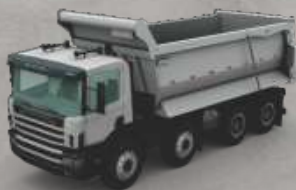
TOMBREAUX DE CHANTIER
