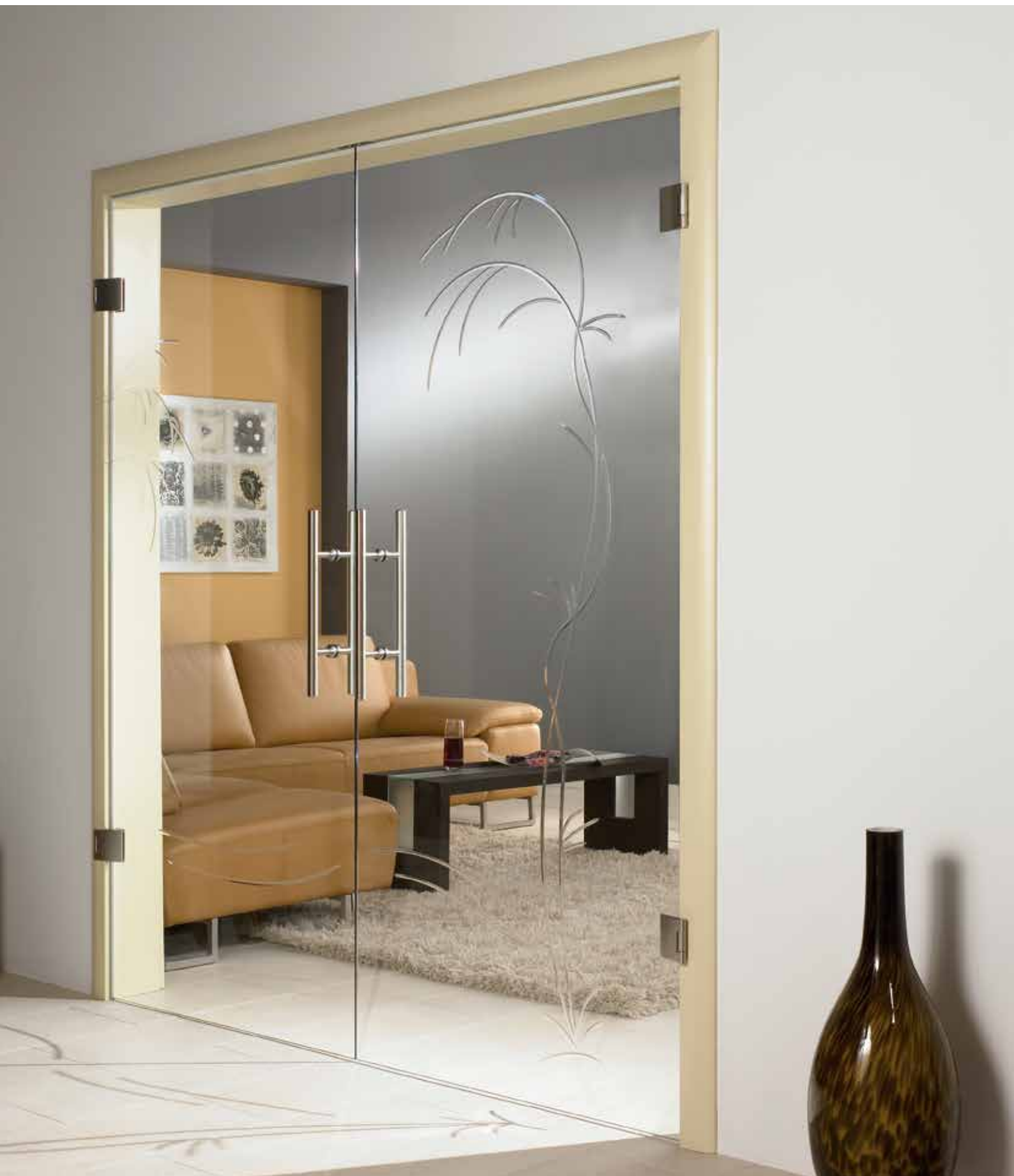
Drehtür 2-flg. | Glasdesign: Noblessa und Noblessa Typ 2, V-Rillenschliff poliert auf Float hell | Zarge mit Rollenschnapper-Schließblech oben Griffstange: L&H G 420 rund, Edelstahl matt
