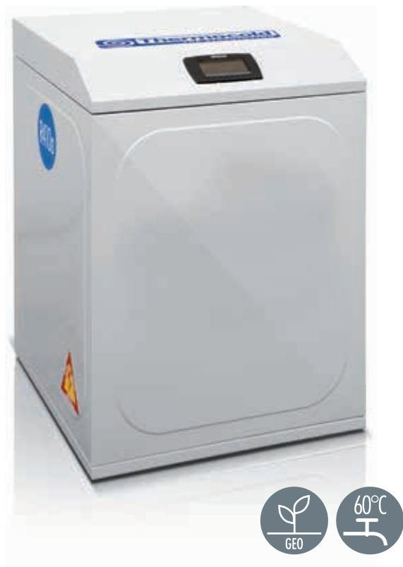
**IT** Refrigeratori e pompe di calore geotermiche con valvola a quattro vie per inversione sul circuito gas, con compressori scroll ad alta efficienza e scambiatori maggiorati.
