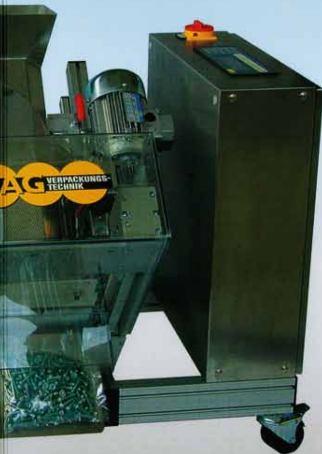
Unser Folienverpackungsautomat ist auch als VPM 400 für eine maximale Beutelbreite von 400 mm lieferbar.
