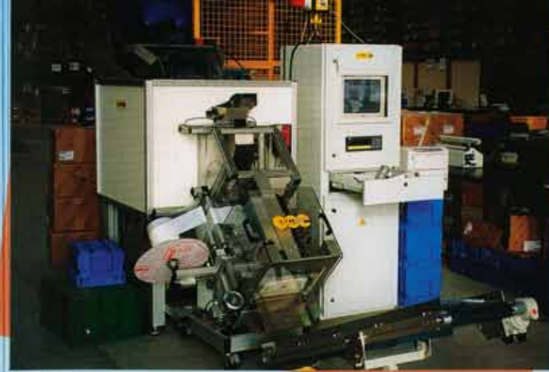
VPM 250 mit vollautomatischer Zählwaage.
