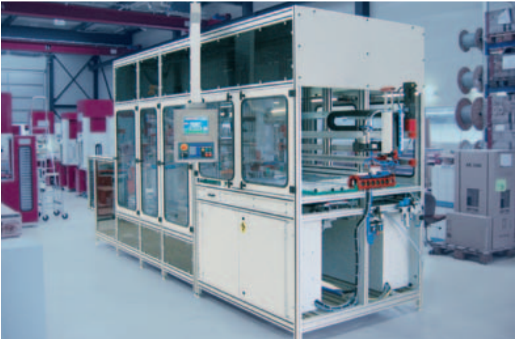
◀ Flexible Montagezelle mit Lift Flexible assembly cell with lift Cellule de montage flexible avec ascenseur LCA Automation AG, Affoltern, CH
