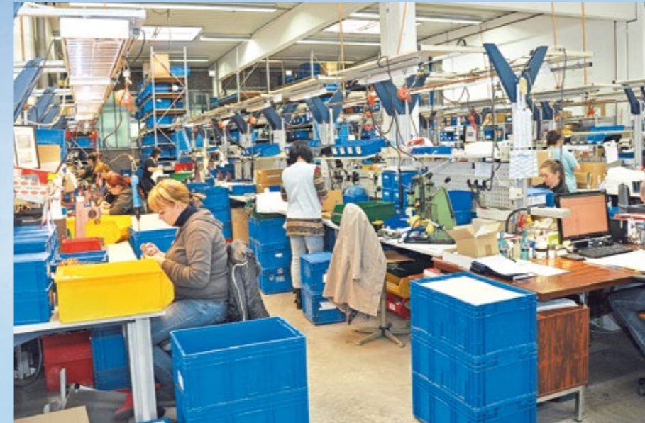
In der Montage werden aus Gehäusen, Kartuschen, Kabeln und Schläuchen komplette Armaturen gefertigt. Der größte Teil der Einzelteile wird im Haus produziert. Und natürlich auch auf Herz und Nieren getestet – Qualität steht oben an.
