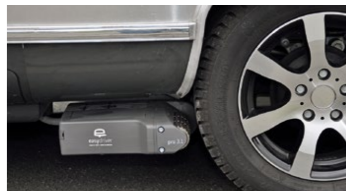
Hightech in Kunststoff: Die Gehäuse sind nicht nur sehr flach und ausgesprochen rostresistent, es gibt sie auch farblich passend zur Aluhaut des Airstream.
