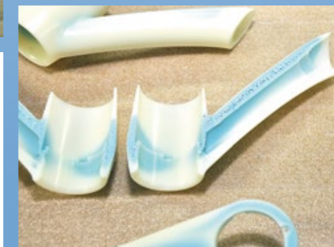
Kunststoff zu gießen, so Steffen Bender, ist selbst bei einem anscheinend simplen Wasserhahn nicht ohne Tücken. Blau eingefärbt macht das innere Material sichtbar, wo es den äußeren Kunststoff durchdringt und so die glatte Oberfläche stört.
