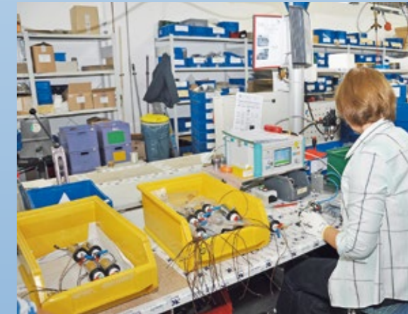
In der Montage werden aus Gehäusen, Kartuschen, Kabeln und Schläuchen komplette Armaturen gefertigt. Der größte Teil der Einzelteile wird im Haus produziert. Und natürlich auch auf Herz und Nieren getestet – Qualität steht oben an.
