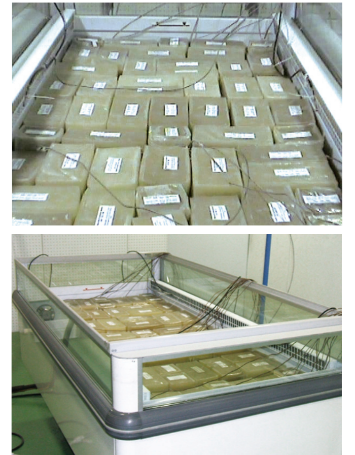
9. Imágenes de un expositor horizontal abierto (modelo COPI-190) durante los ensayos de caracterización conforme a la normativa ISO 23953 (2) | Pictures of test climate room with an open horizontal refrigerated display cabinet (COPI-190 model) loaded according to ISO-23953 (2) | Images d'un meuble horizontal ouvert (Modèle COPI-190) durant les essais de caractérisation suivant la Norme ISO 23953
